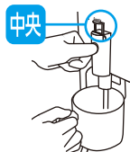
チャイルドロックボタンを押しながら、レバーを押すと出てきます。
